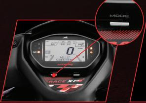
PRESS THE MODE BUTTON BELOW THE SPEEDOMETER
